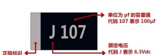
图 1 规格为 6.3V100B 的产品打印标识图示
