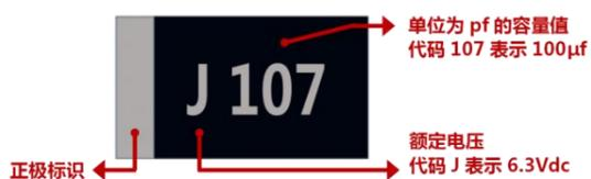
图 1 规格为 6.3V100B 的产品打印标识图示
